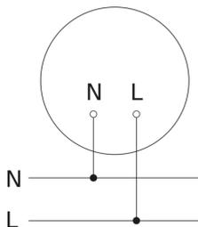
Schema elettrico Master-Master collegamento in rete
